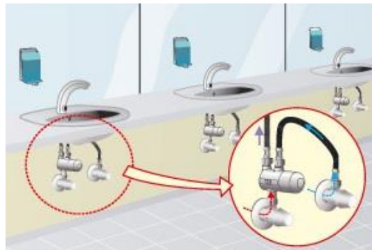
Mitigeur thermostatique positionné en amont et au plus près de la robinetterie
